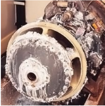
Korrosionstest an einer Turbine
