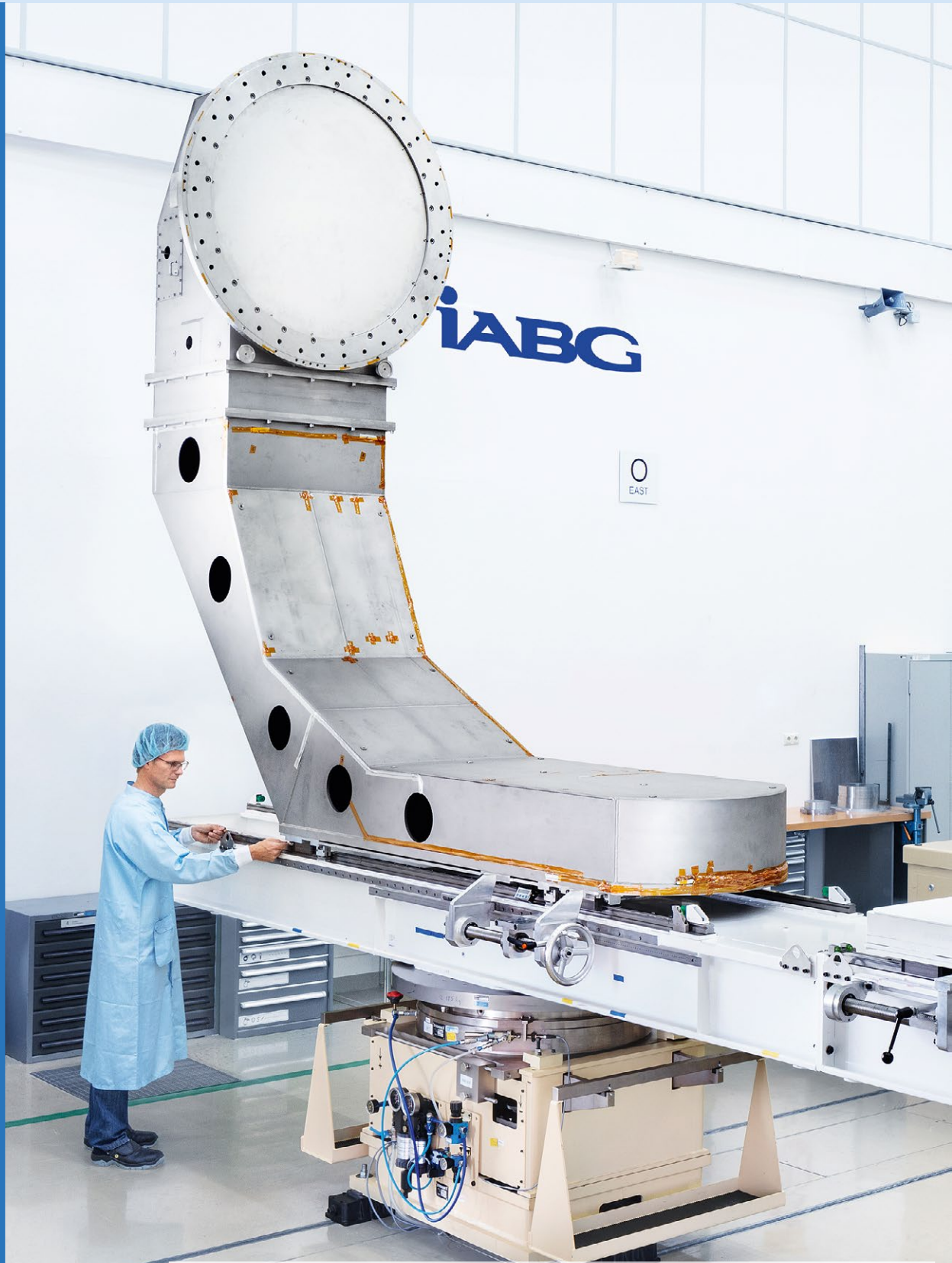
L-Adapter zur Schwerpunkts- und Trägheitsmomentenbestimmung
