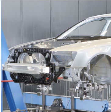
Strukturuntersuchungen an einer Karosserie
