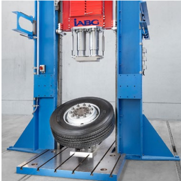
Schlaglochsimulation an einem Rad
