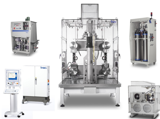
Bild 9: Resonanzfederprüfstand zur Durchführung von Schwingfestigkeitsversuchen unter korrosiver Umgebung Corrosion Spring Tester
