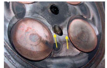
Bild 2. Beispieldarstellung eines typischen TMF-Schadens im Brennraumdach eines Dieselmotors [8]
