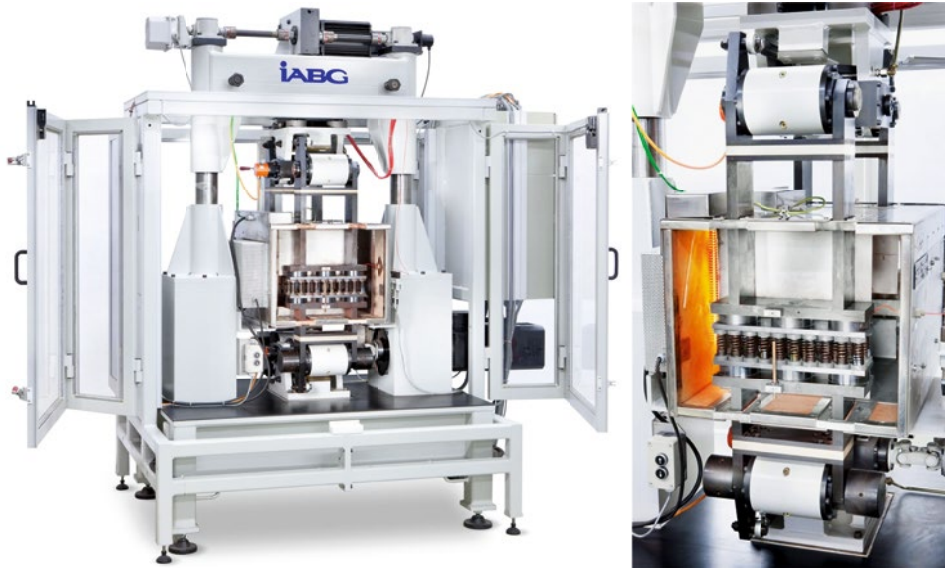
BILD 6 IABG-Resonanzprüfmaschine für Ventildfedern (VSTM)
