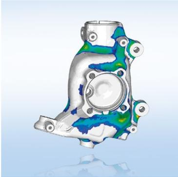
Oben: Betriebsfestigkeitsanalyse eines Schwenklagers
