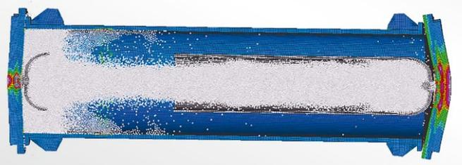
*Simulation Berstkammer: Versagen eines Hochdruckspeichers*
