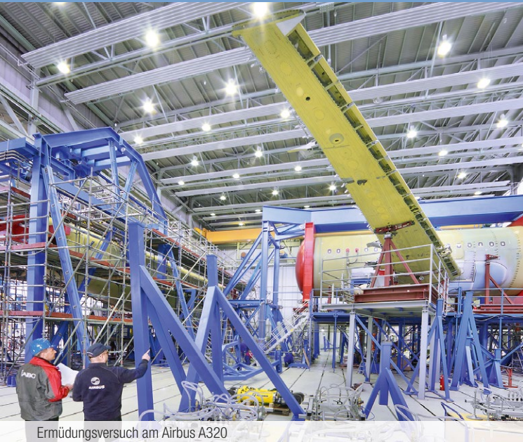
Ermüdungsversuch am Airbus A320
